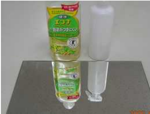
超親水コート剤を一部に塗布した鏡と油、霧吹きを用意します。
