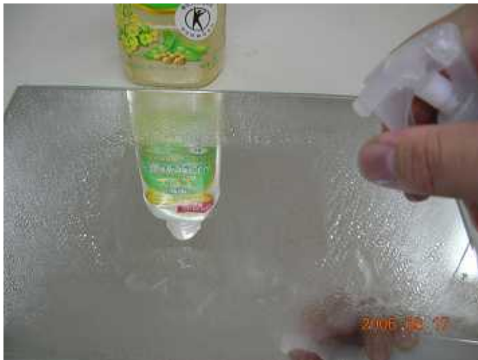
鏡に霧吹きで水をかけます。 (超親水コート剤を塗布した面は油を浮かします。)
